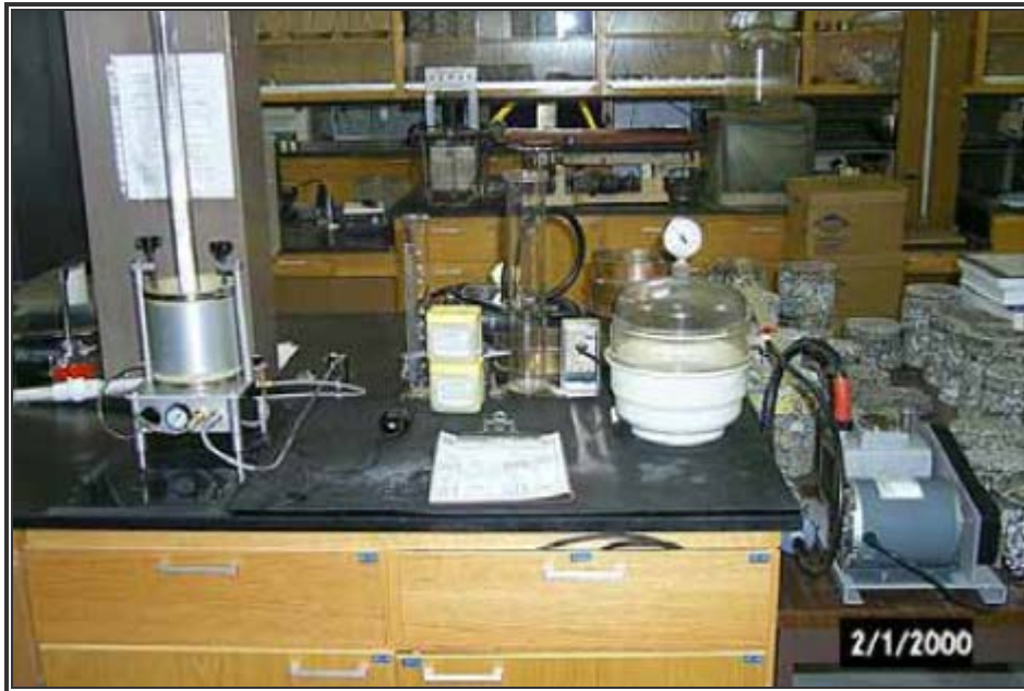
شکل 3-3- نفوذسنج آزمایشگاهی FDOT [5].
