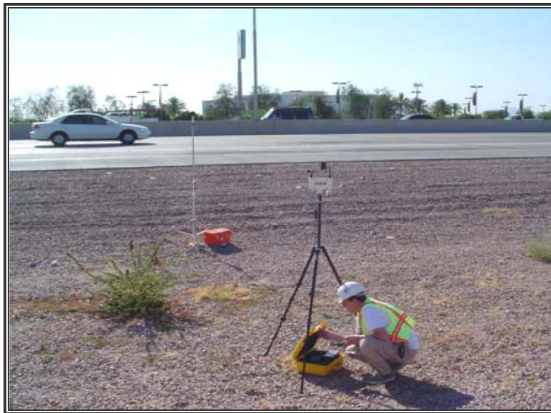
شکل 4-29- روش اندازه‌گیری کنار جاده‌ای [8]
