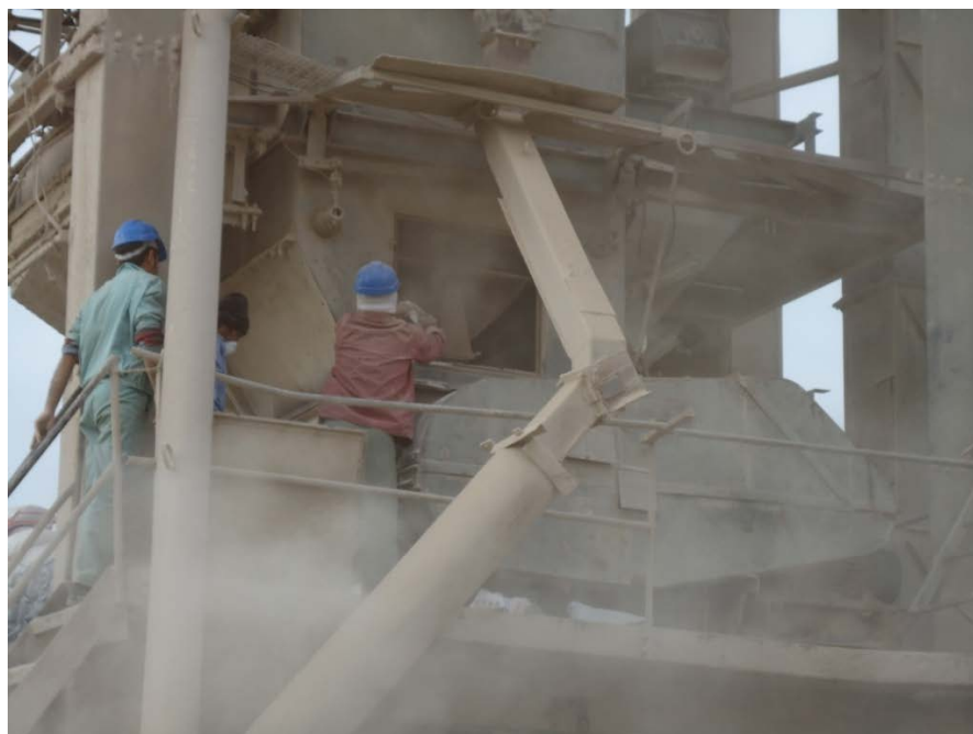
شکل 9-28 اضافه کردن الیاف و فیبر بصورت دستی
