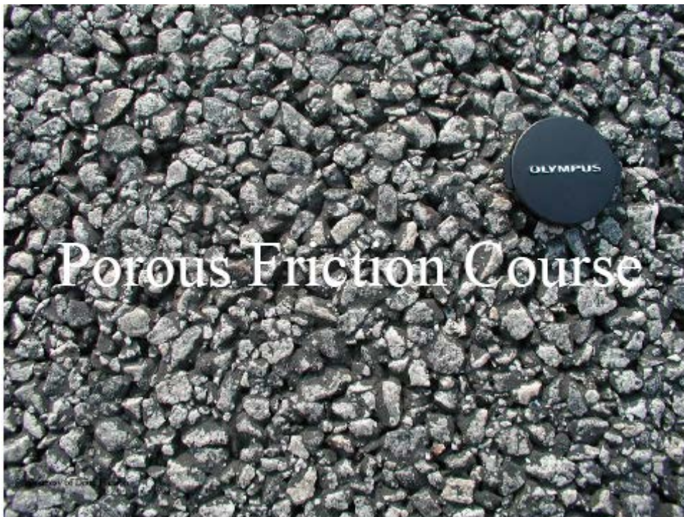
شکل 2-25- نمایی از روبه آسفالت متخلخل در امریکا
