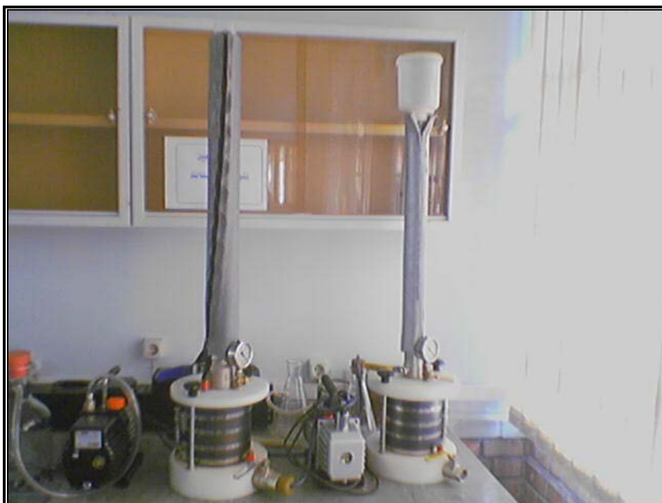
شکل (3-15)- دستگاه نفوذسنج تولیدشده در دانشگاه علم و صنعت ایران
