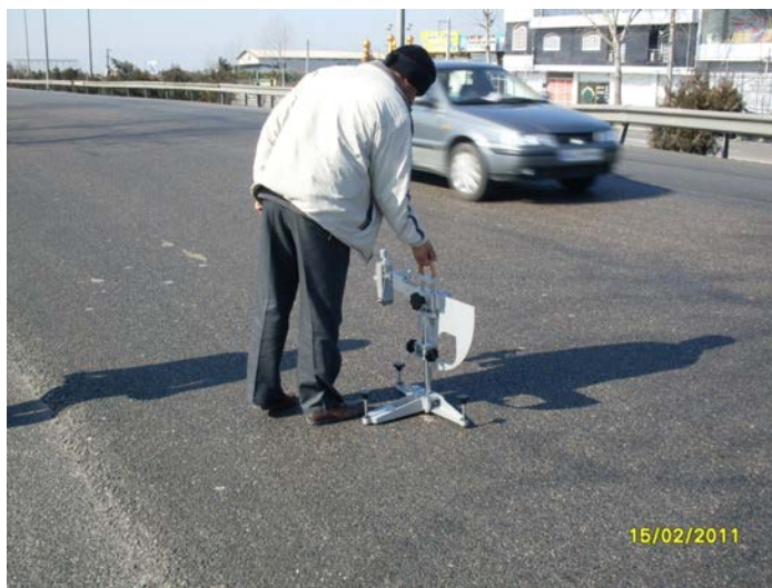
شکل 9-46 انجام آزمایش پاندول انگلیسی بر روی آسفالت متخلخل
