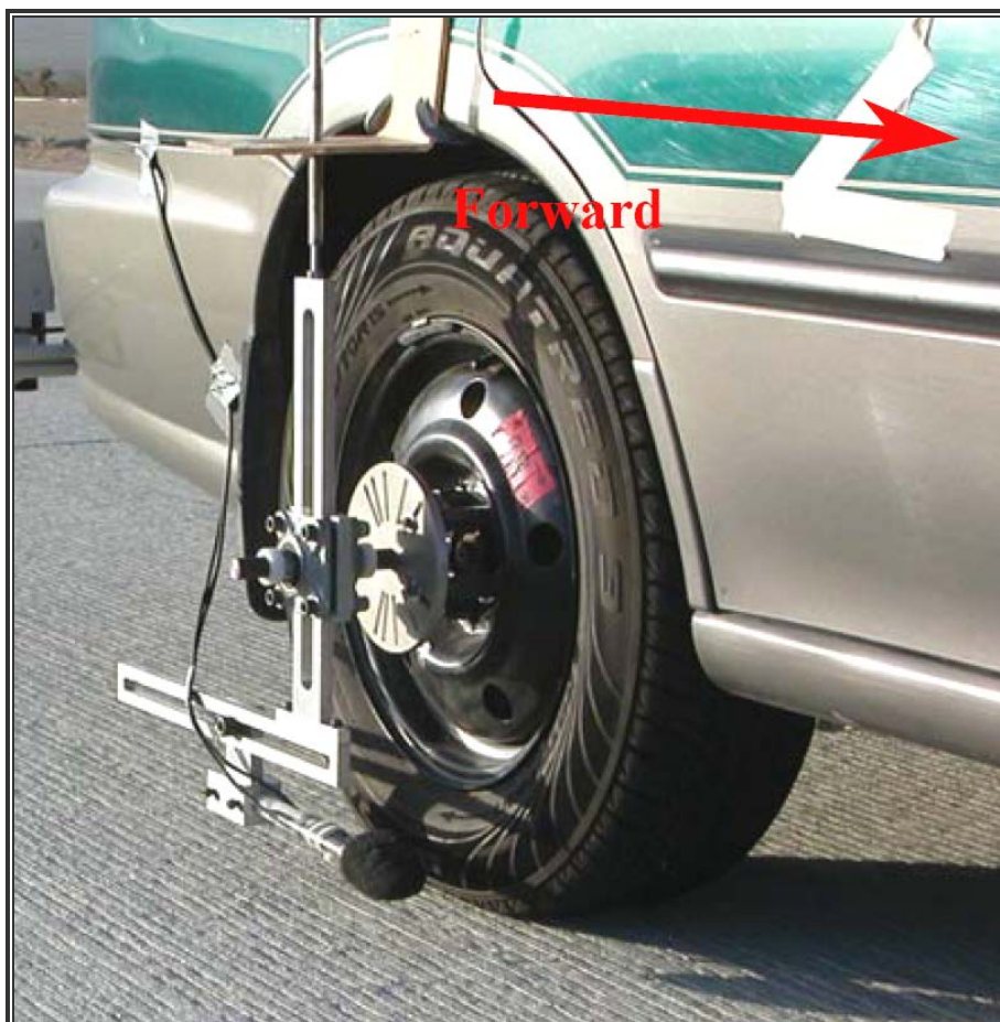
شکل 4-9- جانمایی میکروفن‌های اندازه‌گیری شدت صوت بر روی وسیله نقلیه [4]
