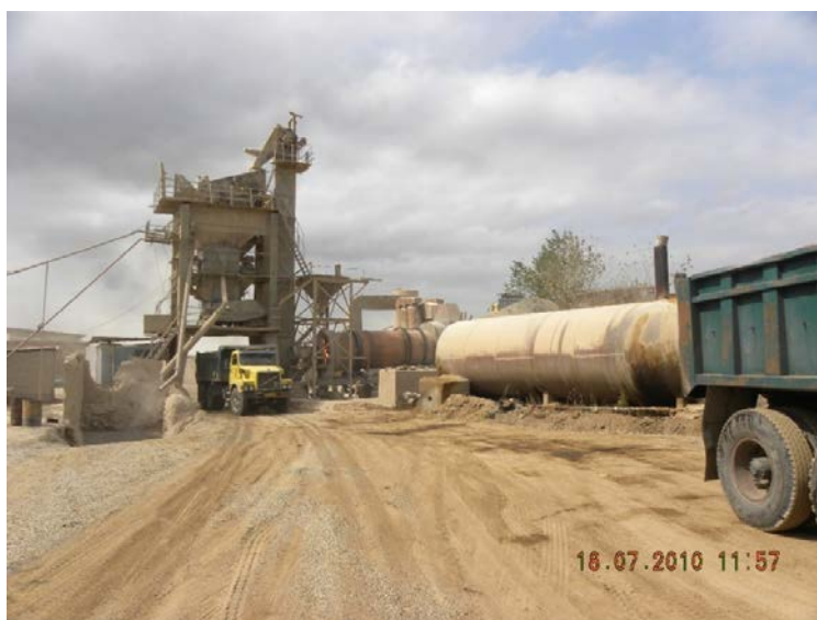
شکل 9-29 کارخانه آسفالت در حین تولید و بارگیری آسفالت متخلخل
