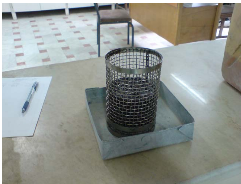
شکل 9-17- سبد انجام آزمایش ریزش قیر
