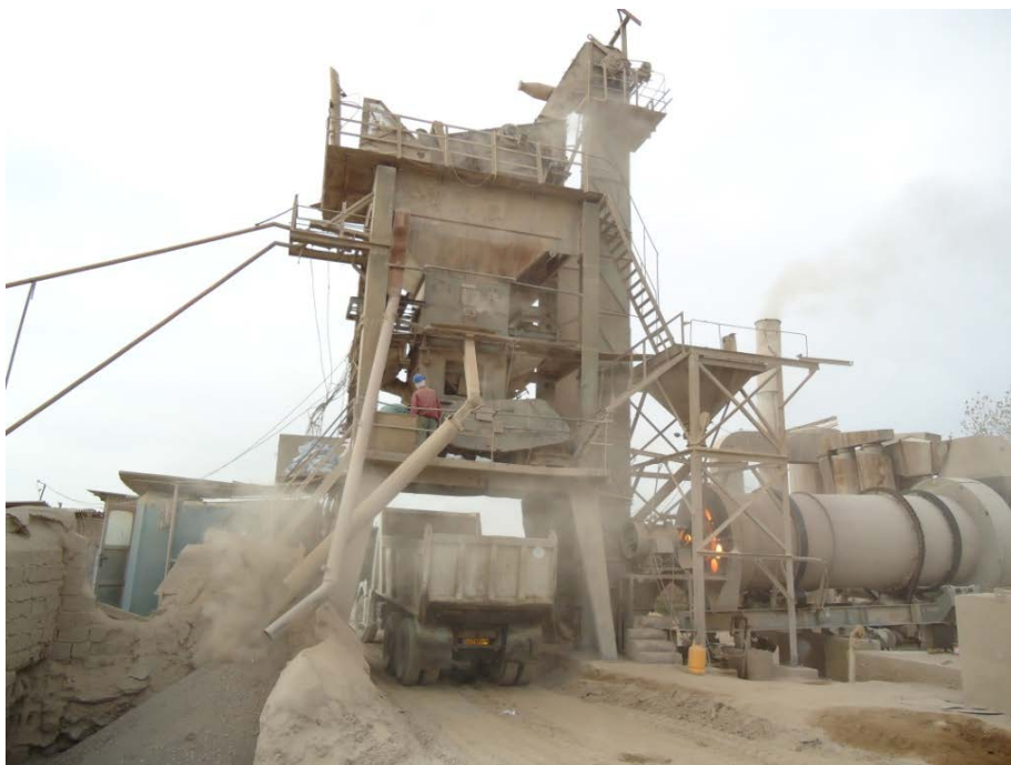
شکل 9-30 کارخانه آسفالت در حین تولید و بارگیری آسفالت متخلخل
