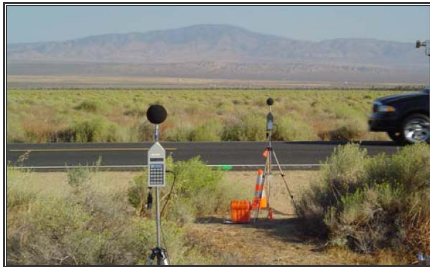
شکل (4-27) - مجموعه متداول اندازه‌گیری صوت بروش کنار مسیر در دو فاصله 7/5 و 15 متری از خط وسط مسیر عبور
