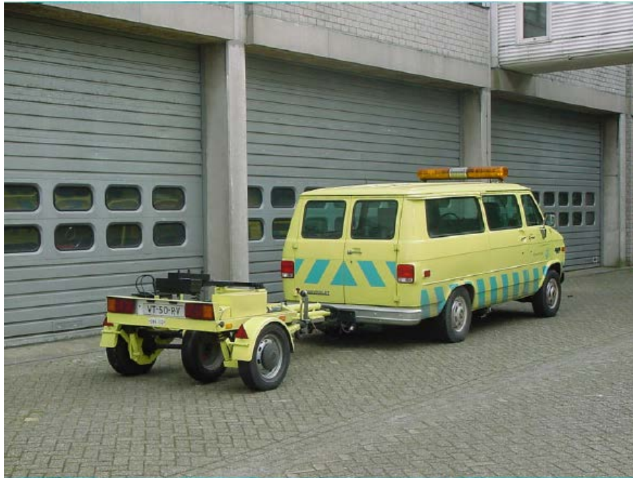
شکل 5-4- تجهیزات اندازه‌گیری مقاومت لغزشی به روش چرخ قفل شده
