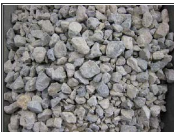
شکل 6-6- مصالح سنگی درشت‌دانه و ریزدانه مصرفی در ساخت مخلوط‌های آسفالتی متخلخل [21].
