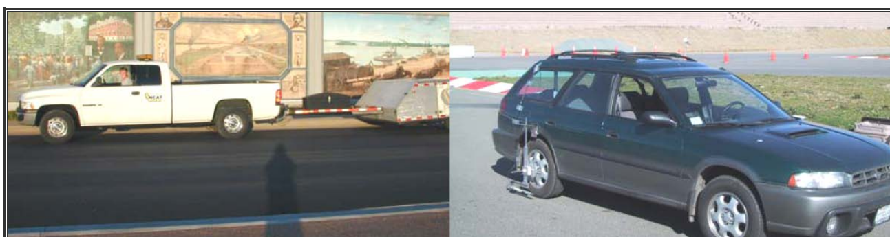
شکل 4-28- مجموعه متداول اندازه‌گیری صوت به دو روش CPI و CPX
