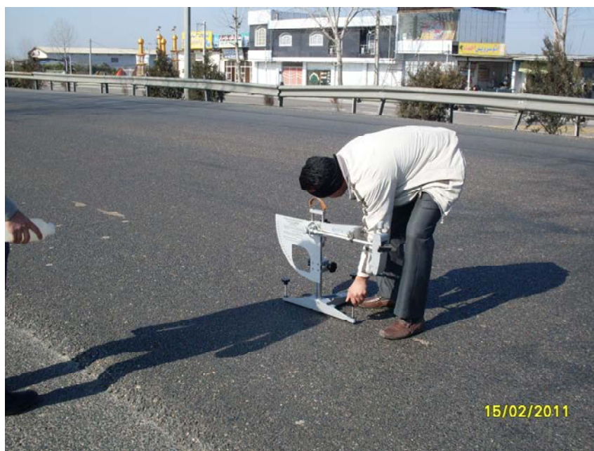
شکل 9-47 انجام آزمایش پاندول انگلیسی بر روی آسفالت متخلخل
