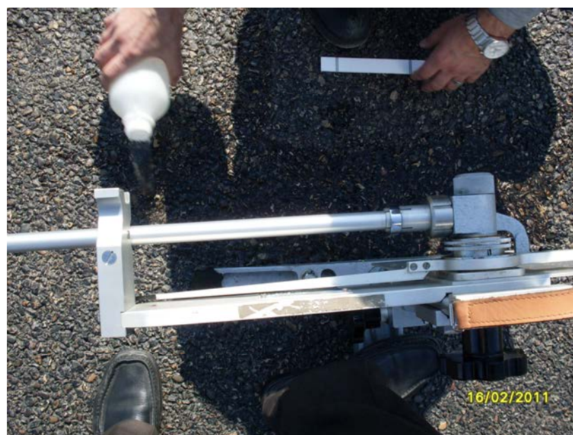
شکل 9-48 انجام آزمایش پاندول انگلیسی بر روی آسفالت معمولی
