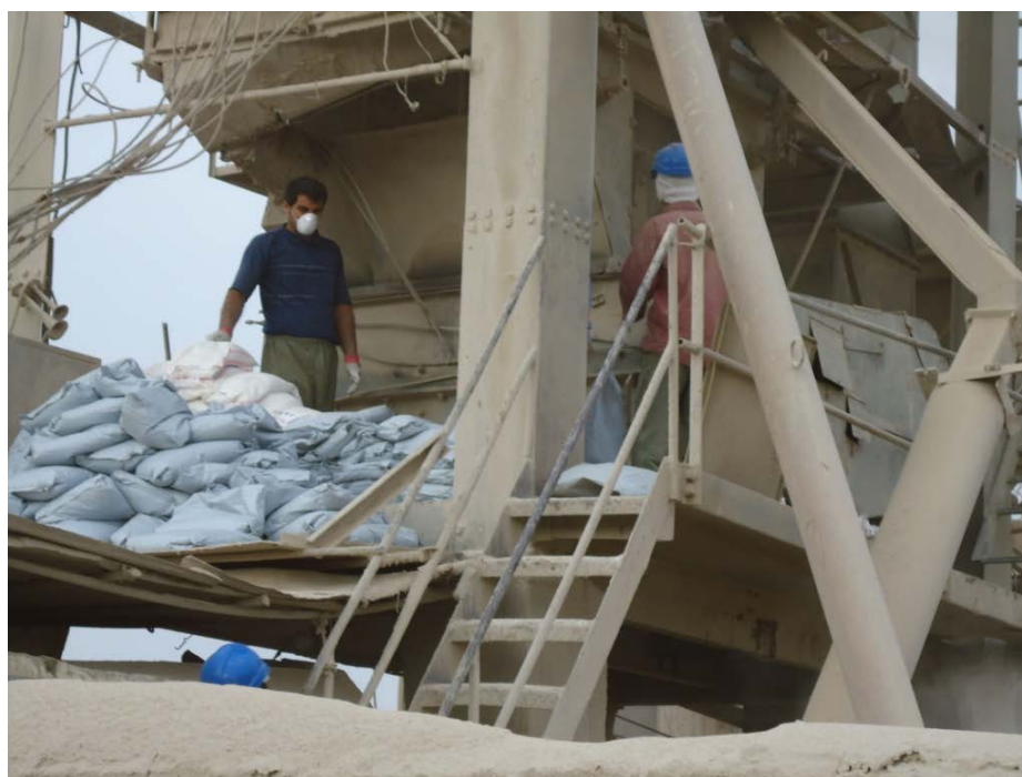
شکل 9-27 اضافه کردن الیاف و فیلر بصورت دستی
