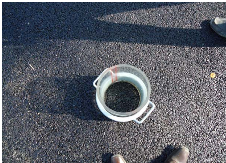
شکل 9-40 آببندی اطراف دستگاه نفوذپذیرسنج برای انجام آزمایش
