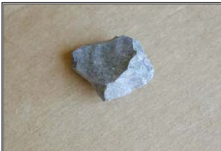
شکل 6-5- سنگدانه‌ای با شرایط مناسب برای استفاده در دانه‌بندی مخلوط آسفالتی متخلخل [4].
