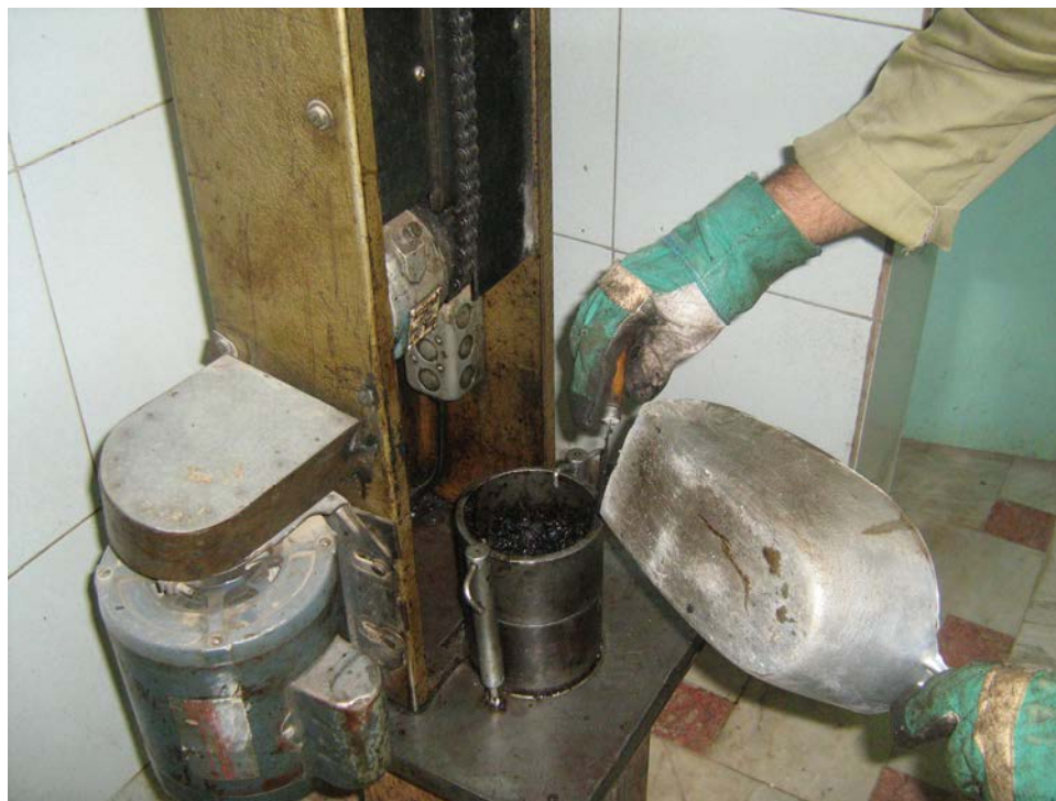
شکل 9-21- تراکم نمونه ها با چکش مارشال
